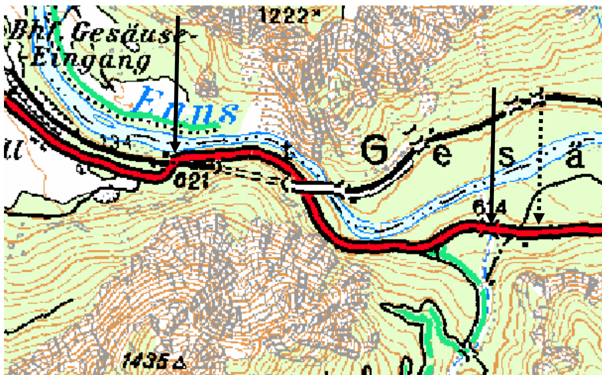
Abb. 17: Abschnitt der Bundesstraße, der für Otter ein besonderes Risiko darstellt. Der zwischen den beiden Pfeilen mit durchgehender Linie befindliche Bereich muss technisch abgesichert werden, allenfalls auch noch 200 m weiter nach Osten bis zum als punktierte Linie ausgeführten Pfeil.
