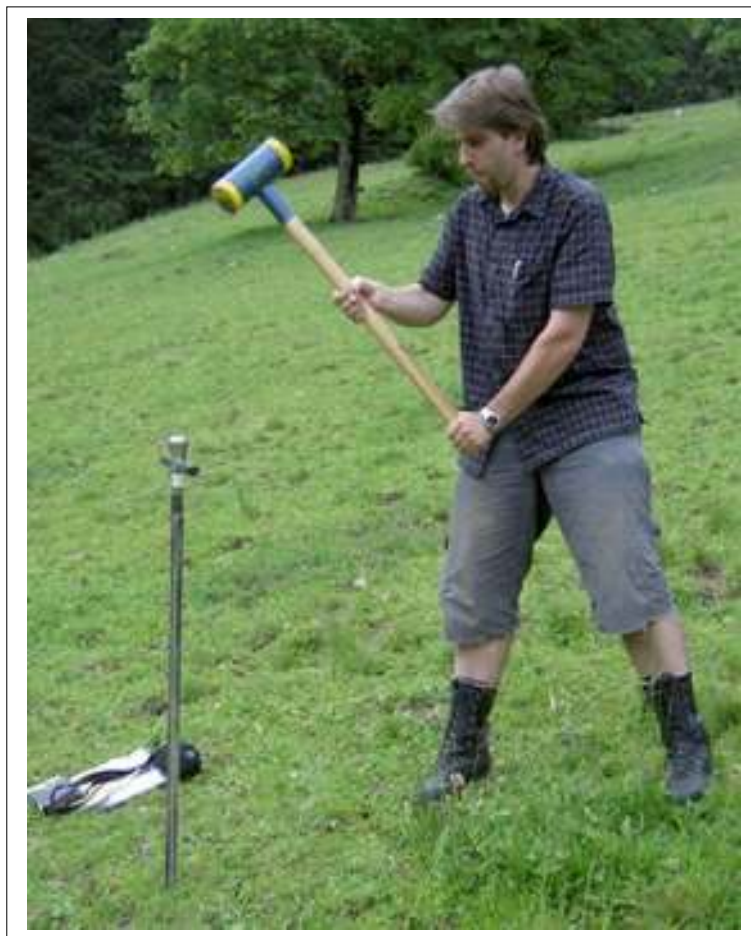
Abb.2: Profilentnahme mittels Schlagbohrer
